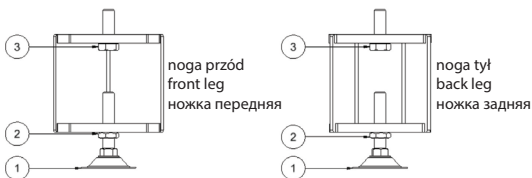
Rysunek 2. Kompletna noga tylna i noga przednia: 1) regulator wysokości; 2) nakrętka kontrolująca; 3) śruba
